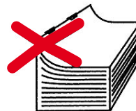
Papier zu dünn - Klammerung trägt auf
